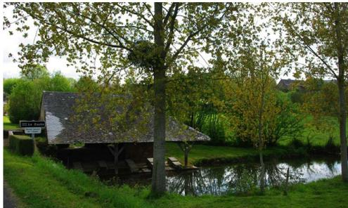
La construction en pierre est surmontée d'une charpente en bois couverte en ardoise. A l'entrée est aménagée une petite salle avec une cheminée probablement pour chauffer l'eau, puis trois marches en grosses pierres irrégulières mènent à la rivière. Cinq tables de lavage en gradin conduisent au niveau de l'eau.
