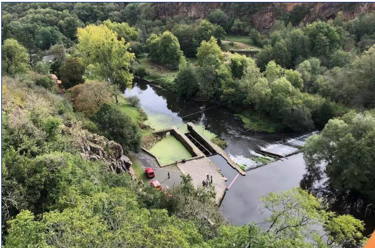
Vue plongeante sur la Maine, photo 2022 prise à partir du porte-vue. On distingue la passe à poissons, la passe à canoës, la chaussée. (Photo : nantesmaville.com)
